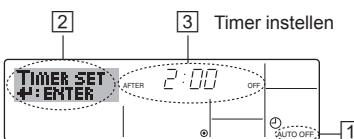
1. Zorg dat u het standaard bedieningsscherm voor u hebt en dat de indicator van de Auto Off-timer (bij ①) op het display wordt weergegeven.
