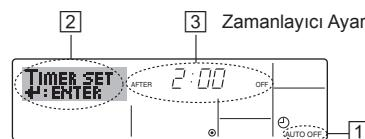
1. Standart kontrol ekranında olduğunuzdan ve ekranda Otomatik Kapanma zamanlayıcısı göstergesinin ① göründüğünden emin olun. Otomatik Kapanma Zamanlayıcısı dışında bir şey görünüyorrsa, işlev seçimi zamanlayıcı işlev ayarını kullanarak onu AUTO OFF TIMER ayarına getirin (bkz. 8.[4]-3 (3)).
