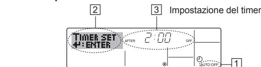
1. Assicurarsi che sia visualizzata la schermata di controllo standard e che l'indicatore corrispondente al timer di arresto automatico ① sia visualizzato sul display.
