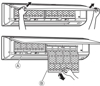
① Двумя руками потяните оба нижних угла воздухозаборной решетки, чтобы открыть ее, затем поднимите фильтр до его фиксации в положении остановки.
