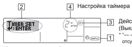
1. Убедитесь, что отображается стандартный экран управления, а также индикатор простого таймера (①).
