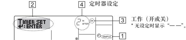
1. 确定正在标准控制屏幕, 显示器 (①) 上可见简单定时器指示器。当所显示的不是“简单定时”时, 请使用遥控器 (参阅 8.[4]-3 (3)) 定时器功能设置的功能选择设置它为“简单定时”。
