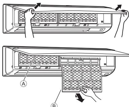
① 用双手持进气格栅的底部两端，拉起格栅，然后将过滤网提起直到其卡到停止位置。
