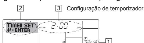
1. Certifique-se de que o mostrador é um mostrador principal de controlo e que a indicação Auto Off (Desligar automático) aparece no mostrador (em ①). Quando aparece uma indicação diferente de Auto Off Timer (Temporizador Desligar automático), active AUTO OFF TIMER utilizando a selecção de função (consulte 8.[4]–3 (3)) da programação da função de temporizador.
