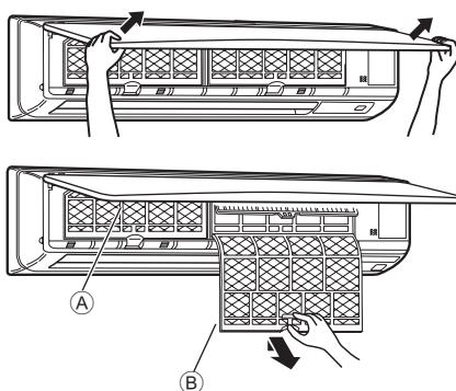
① Puxe a grelha de admissão pelos cantos inferiores, com as duas mãos, para a abrir e depois levante o filtro até encaixar com um estalido na posição de paragem.
