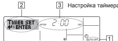
1. Убедитесь, что отображается стандартный экран управления и индикатор таймера отключения (Auto Off) (1).
