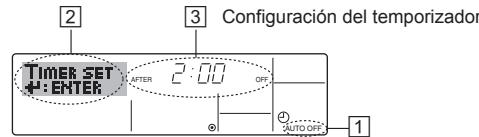
1. Asegúrese de que usted se encuentre en una pantalla de control estándar y que el indicador del temporizador de apagado automático Auto Off se muestre en la pantalla (en ①).
