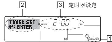
1. 确定在标准控制屏幕上, 显示器可见自动关闭定时器指示器 (①)。当所显示的不是“自动关机定时”时, 请使用遥控器 (参阅 8.[4]-3 (3)) 定时器功能设置的功能选择设置它为“自动关机定时”。
