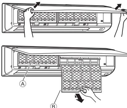
① Con ambas manos, tire hacia afuera de las esquinas inferiores de la rejilla de entrada para abrirla y levante el filtro hasta que encaje en la posición de tope.
